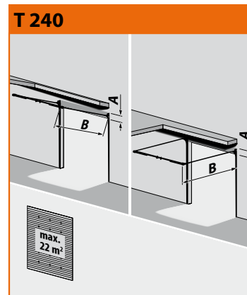
T 240 Laaginbouw railsysteem, binnenliggende kabels + stalen draagprofiel
